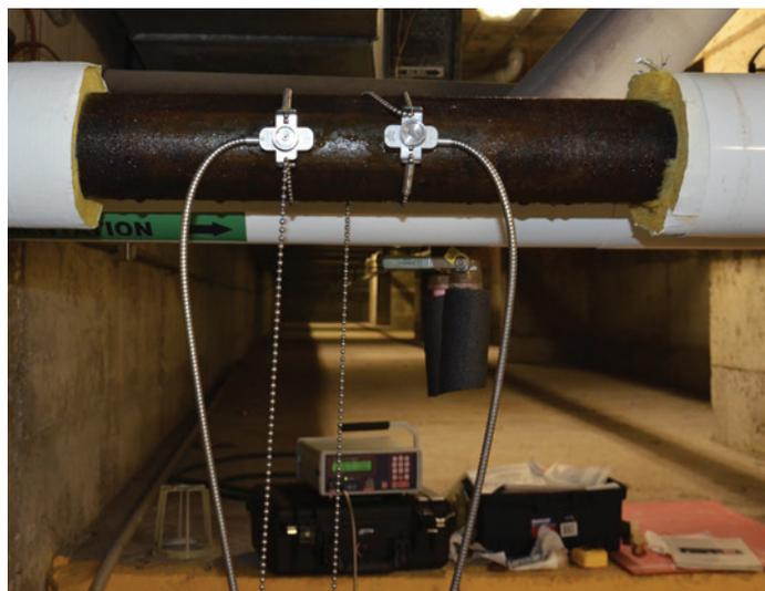
FIGURE 2 : MESURE PONCTUELLE DU DÉBIT CIRCULANT DANS LE CHAMP GÉOTHERMIQUE À L'AIDE D'UN DÉBITMÈTRE À ULTRASONS PORTATIF.
